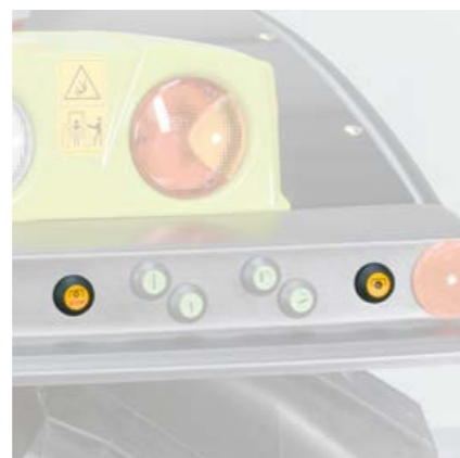
Le bouton jaune extérieur sur l'aile permet d'embrayer la prise de force. Le commutateur jaune en cabine permet également de débrayer rapidement la prise de force en cas d'urgence.
