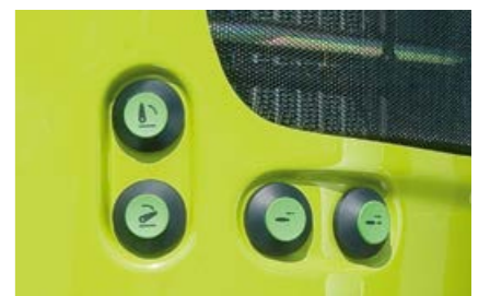
Commandes extérieures du relevage avant et d'un distributeur sur l'avant du capot moteur.
